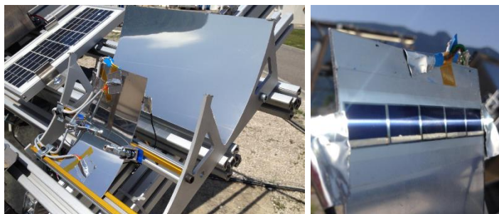
Figure 2. Prototype HIRL sur tracker en extérieur (gauche) et vue des cellules sous rayonnement concentré (droite).
