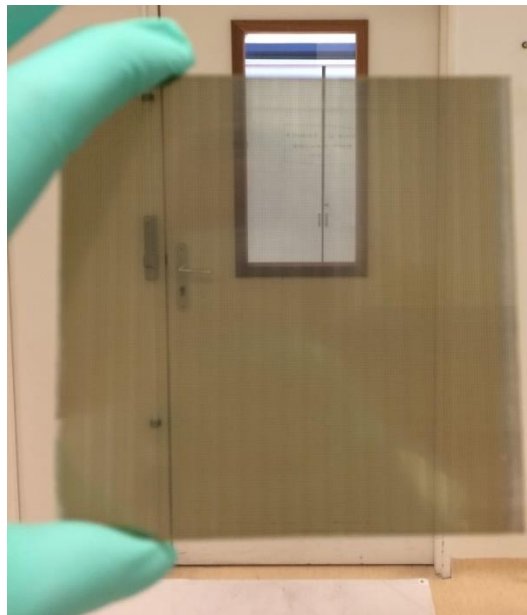
Figure 1 - Photographie d'un échantillon 10x10 cm 2 avec un taux d'ouverture de 55 %
